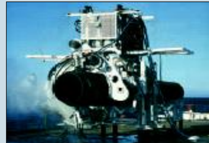
Módulo de remoção de concreto
